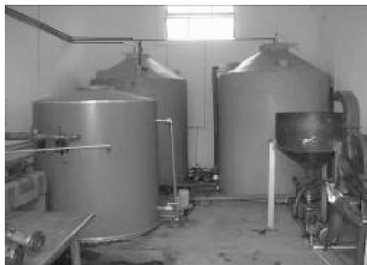
图1 5\text{m}^3 中温厌氧发酵系统
